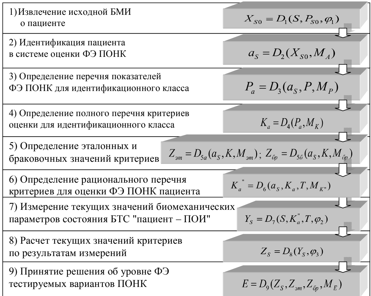
Рисунок 2 - Модель унифицированной оценки функциональной эффективности протезирования и ортезирования пациентов с патологией нижних конечностей.
