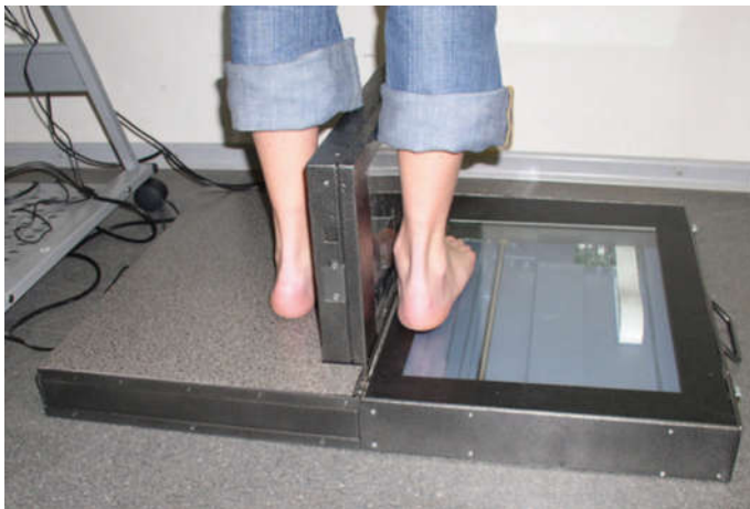
Рис. 3 Оборудование комплекса «Скан мобильный»: а — трехкоординатное сканирующее устройство в разобранном виде; б — чемодан-укладка с компьютерной аппаратурой и трехкоординатное сканирующее устройство в собранном виде
