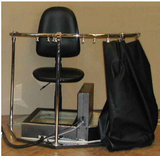
Рис. 2 Основные модули регистрации биомедицинской информации в комплексе «Скан» в стационарном варианте исполнения: а — модуль для сканирования стоп (с подиумом, трехкоординатным сканером и креслом для пациента); б — модуль для сканирования рентгенограмм стопы
