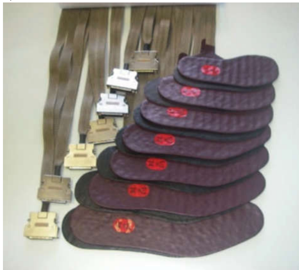
Рис. 6 Комплектующие ПАК «ДиаСлед-М»: а — набор измерительных стелек в обычной комплектации (семь пар — от 17-го до 28-го размера); б — блок сопряжения с установленным на него для подзарядки блоком преобразования
